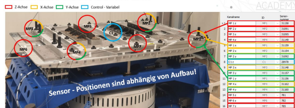
Aufbau und Position der Sensoren
